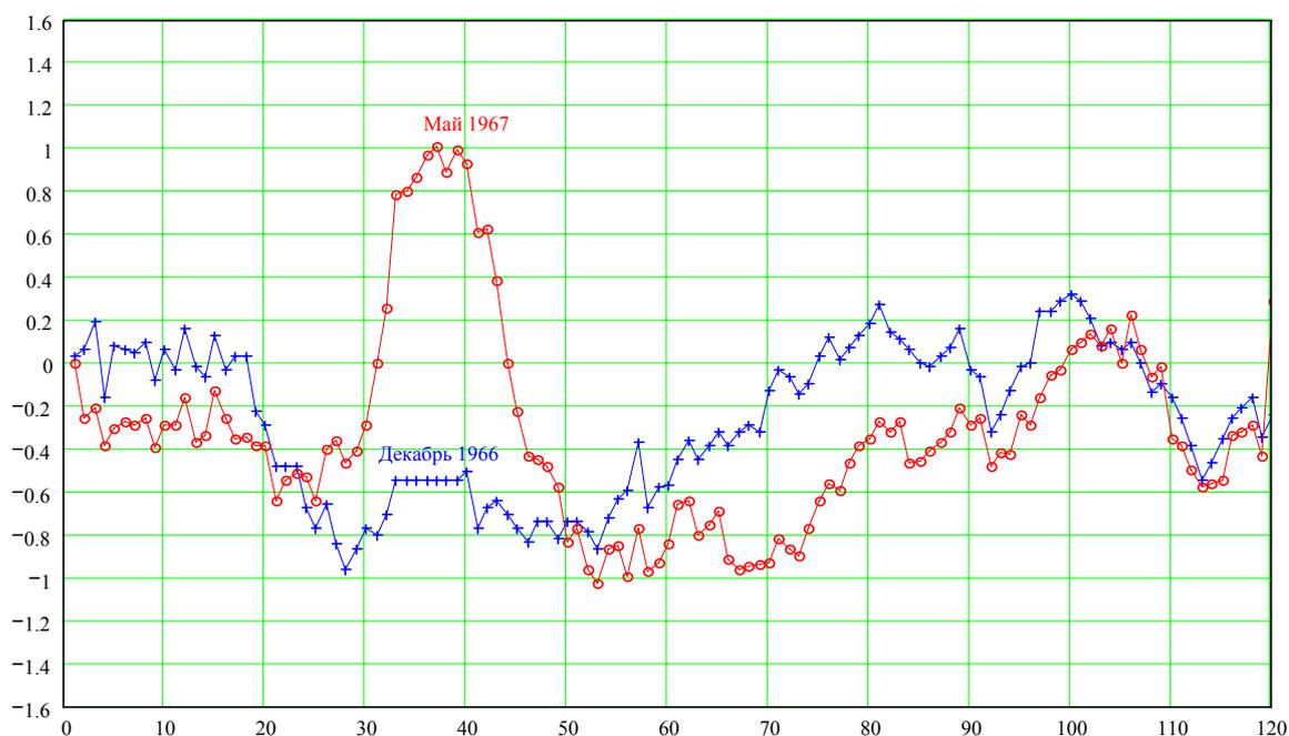
Рис.2: Высотное положение в мм центров магнитных блоков с номерами N :
